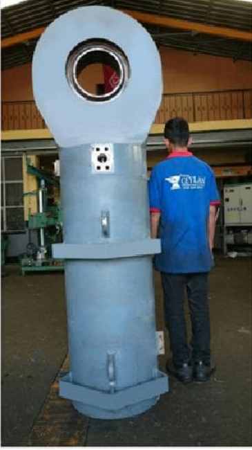
Çimento Farin Değirmeni Hidrolik Silindiri
