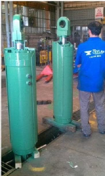
Su Soğutmalı ve Rot Korumalı Demir Çelik Hidrolik Silindiri
